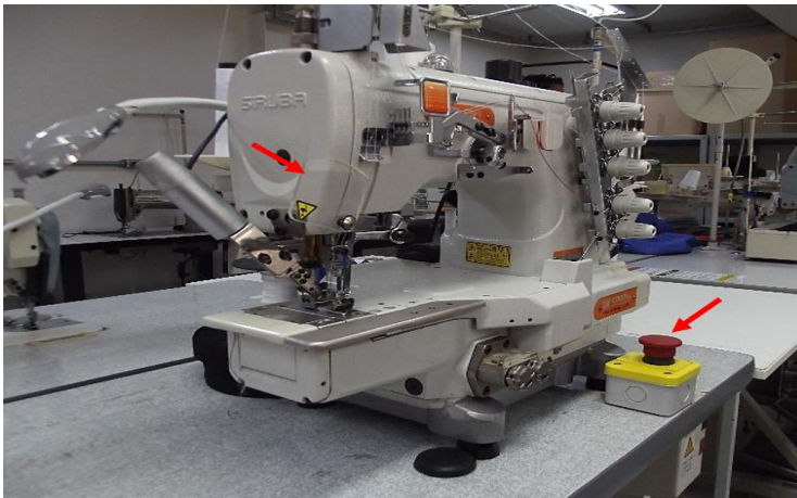
Figura: Máquina com sistemas de proteção instalados (botão de emergência e proteção móvel da agulha. A proteção móvel é abaixada pelo operador antes de iniciar a atividade de costura) |Foto: Autores, 2022.
