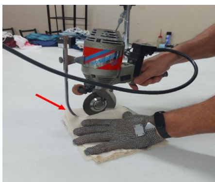
Figura: Exemplo de corte de tecido com tesoura elétrica (máquina de corte) com utilização de luva de malha de aço.
