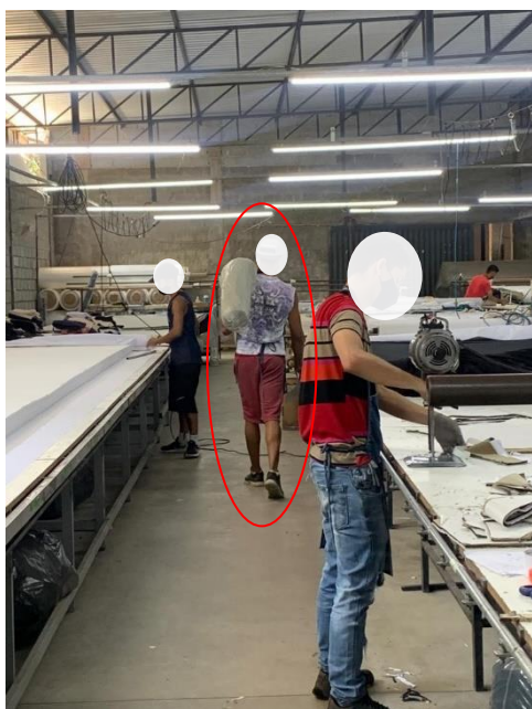
Foto: Transporte manual de carga sem utilização de meios auxiliares para reduzir esforço físico e sobrecargas. Autores, 2022.
