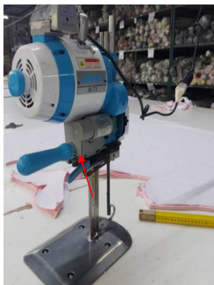
Foto: Utilização de fita crepe para prender a fiação de alimentação da máquina de corte. Deve-se utilizar fita isolante, preferencialmente de alta fusão que suporta aquecimento gerado pelo uso da máquina. Autores, 2022.
