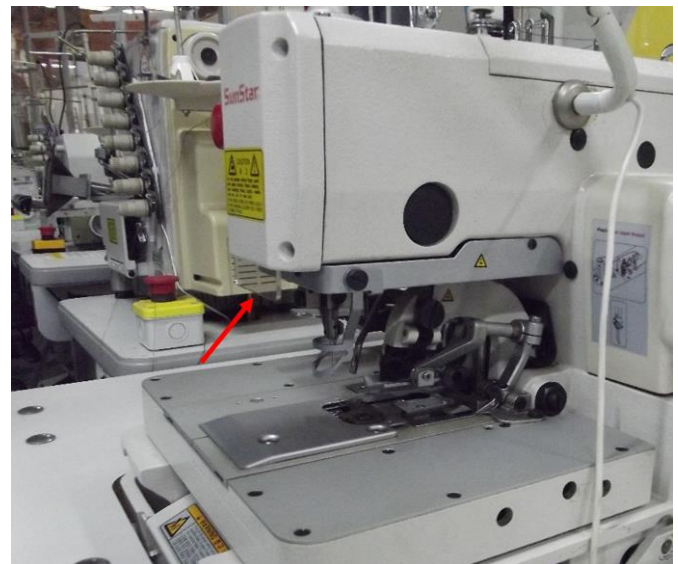
Figura: máquina caseadeira com anteparo de proteção pequeno. O risco de projeção da agulha em caso de quebra, permanece. | Foto: Autores, 2022.
