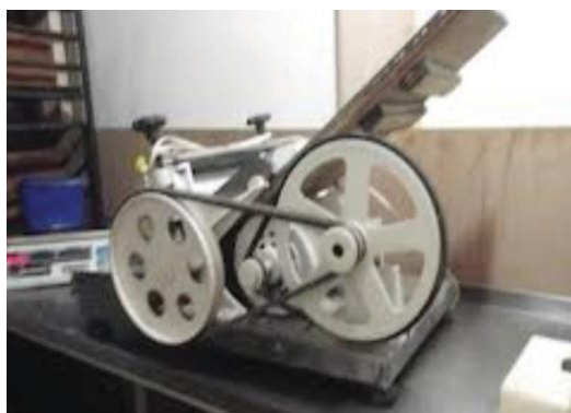
Figura 3 – Equipamento de panificação sem proteção nas partes móveis.
