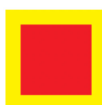
Sinalização de Solo para Equipamento de Combate a Incêndio
