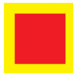
Sinalização de Solo para Equipamento de Combate a Incêndio
