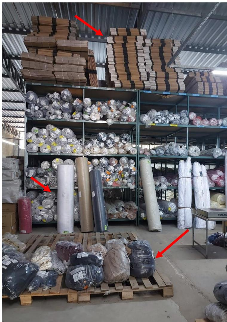
Figura 11: materiais armazenados fora das prateleiras obstruindo vias de circulação. Pilhas instáveis de materiais gerando risco de acidentes. | Foto: Autores, 2022.
