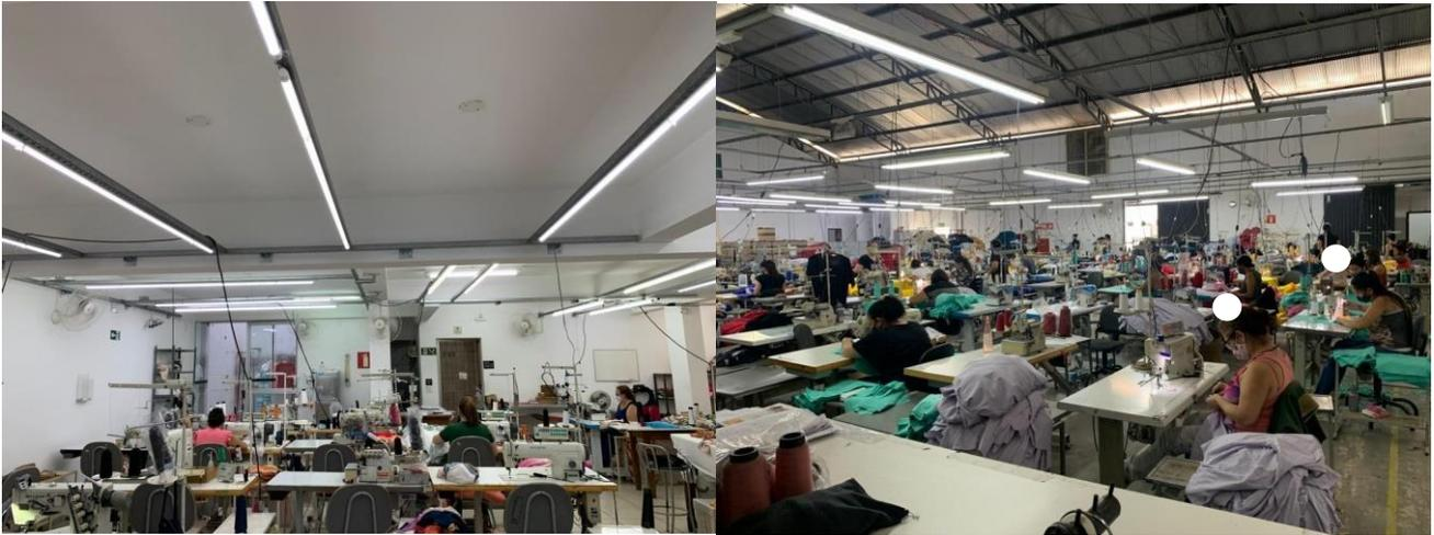
Figura 28: Iluminamento natural com luz geral e localizada – conforto visual. Ausência de iluminação e ventilação naturais. Temos ainda superfícies de trabalho reflexivas. | Foto: Autores, 2022.
