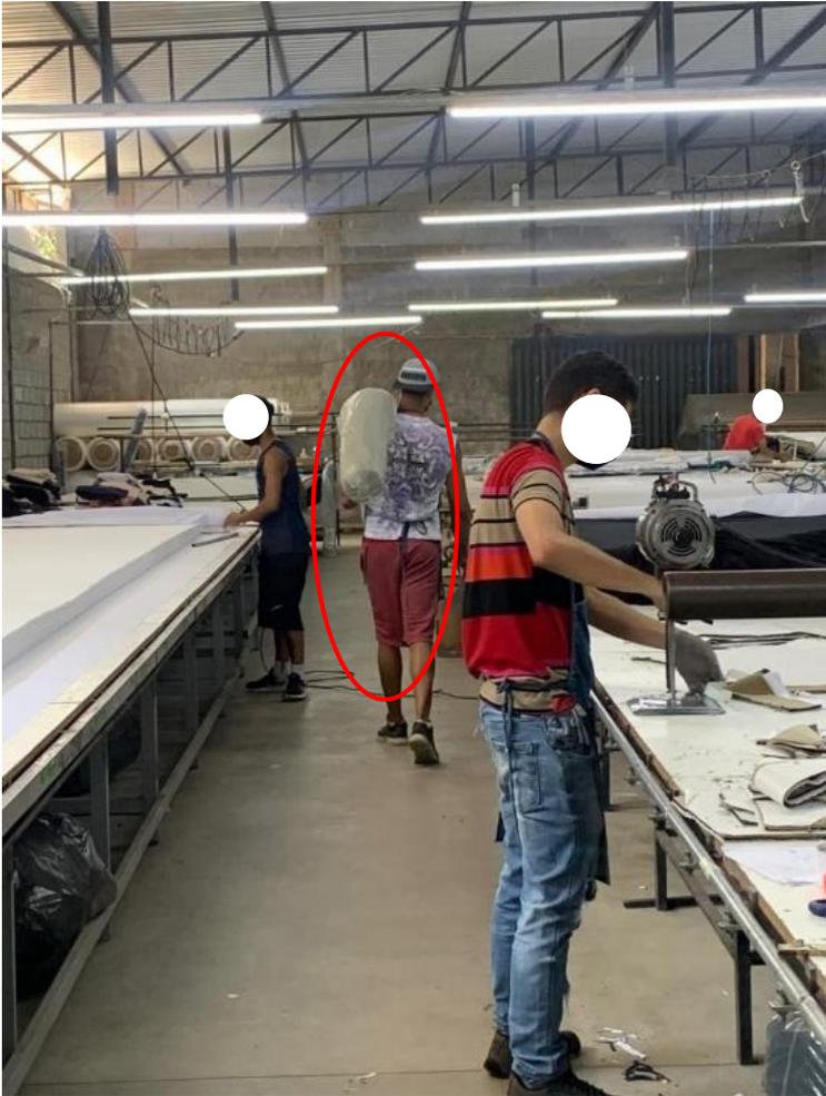
Figura 21 – transporte de carga sem utilização de meios auxiliares para reduzir esforço físico e sobrecargas. | Foto: Autores, 2022.
