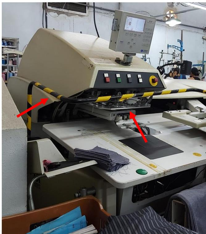
Figura 12: instalada barra metálica na máquina de pregar bolsos para sinalizar a área de risco, no entanto o operador tem acesso à zona perigosa. Deve-se verificar a possibilidade de instalação de detectores de presença optoeletrônicos impedindo que a máquina inicie os movimentos perigosos (prensa e costura do bolso) caso seja detectado que o operador está com os braços e mãos na zona de risco. | Foto: Autores, 2022.
