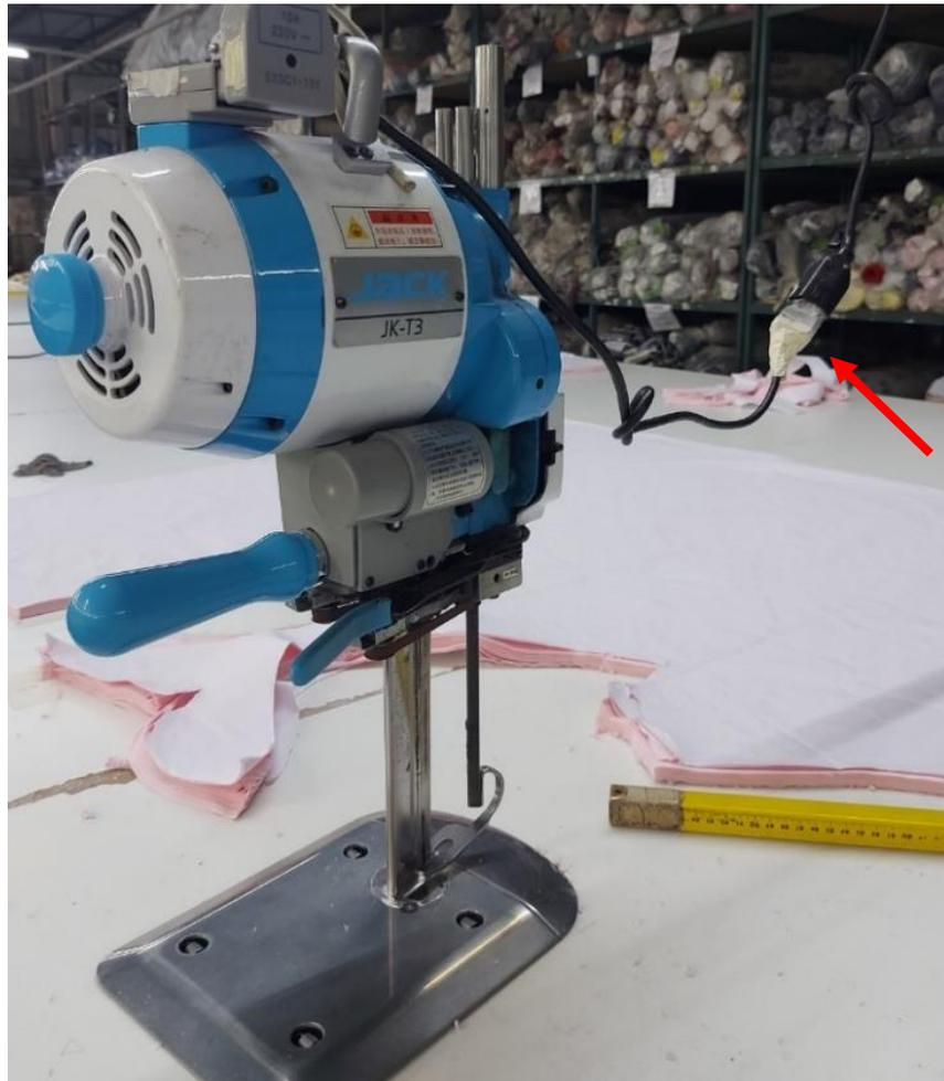
Figura 15: utilização de fita crepe para prender a fiação de alimentação da máquina de corte. Deve-se utilizar fita isolante, preferencialmente de alta fusão que suporta aquecimento gerado pelo uso da máquina. | Foto: Autores, 2022.
