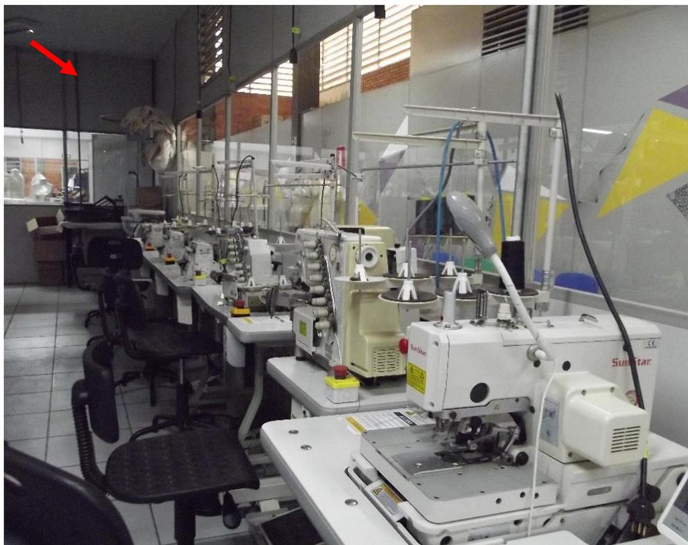
Figura 4: Postos de trabalho com iluminação deficiente. Todos os setores devem possuir níveis de iluminação adequados. | Foto: Autores, 2022.
