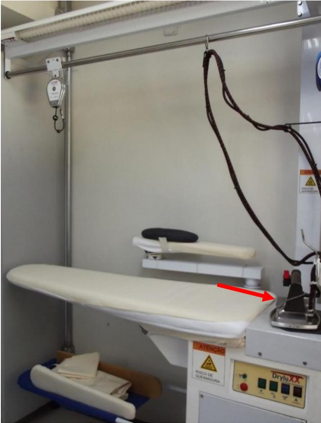
Figura 5: Mesa de passar roupas industrial, com apoio para o ferro na posição horizontal. | Foto: Autores, 2022.
