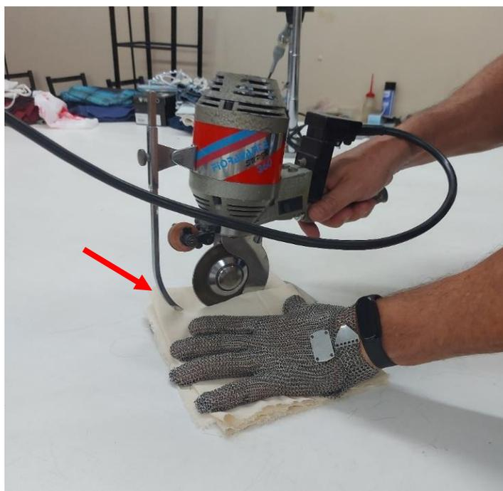
Figura 6: exemplo de corte de tecido com tesoura elétrica (máquina de corte) com utilização de luva de malha de aço. Os tecidos infestados possuem grandes dimensões, exigindo maior esforço postural para alcançar toda a área de corte na bancada, aumentando o risco de cortes em membros superiores. | Foto: Autores, 2022.
